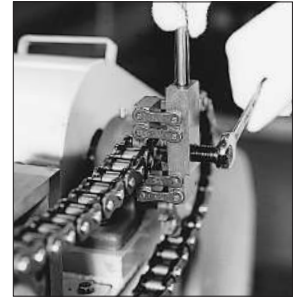
圖5. 使用鏈條分解器的切削方式
