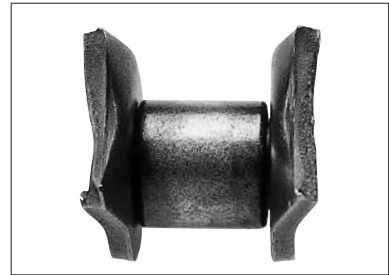
③ 偏置鏈板的疲勞造成的斷裂
