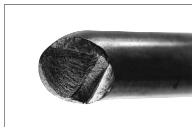
③ 衝擊導致的彎曲斷裂
