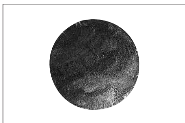
② 疲勞造成的斷裂
