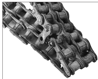
圖34. 不鏽鋼滾子鏈條的腐蝕情形
