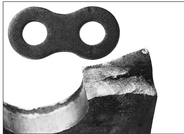
② 疲勞造成的斷裂
